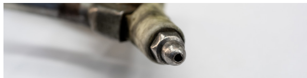
Eine offene 1/4-Zoll-Düse, die für die Kühlung der Mitarbeiter verwendet wird, entspricht ungefähr 15 PS Druckluft.
